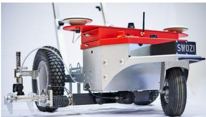
La machine de marquage SWOZI est en aluminium léger et facile à contrôler grâce aux poignées.
